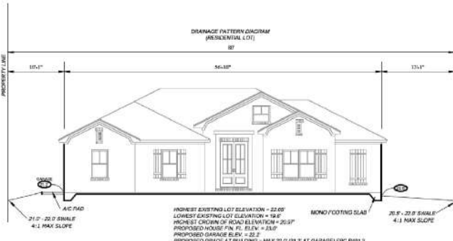
LOT GRADING DETAIL SCALE: N.T.S.
